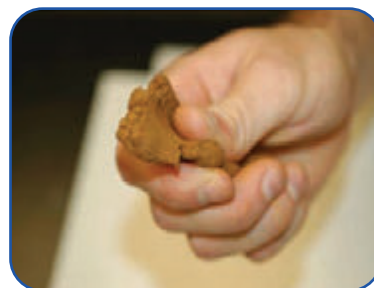
3) mexanik tarkibi o'rta soz tuproqni lenta shakliga keltirish jarayoni
