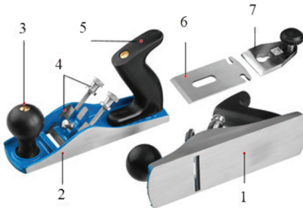
21-rasm. Randaning tuzilishi: 1 – taglik; 2 – asos; 3 – oldingi dasta; 4 – tig'ni rostlash moslamasi; 5 – orqa dasta; 6 – tig'; 7 – payrahani sindiruvchi va tig'ni siqib turuvchi pona.
