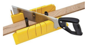
20-rasm. Porsi qolip yordamida arralash
