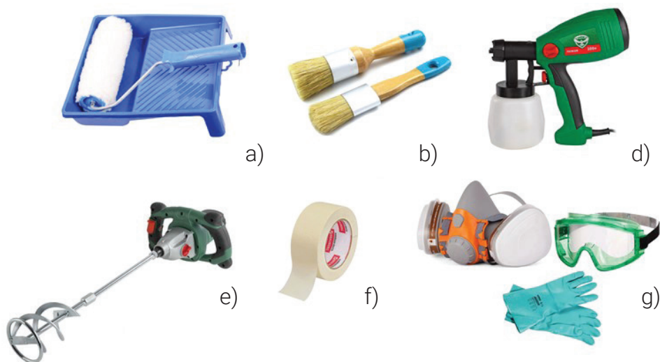
85-rasm. Bo'yashda ishlatiladigan asbob-uskuna va moslamalar: a) valik va taglik; b) cho'tka; d) pulverizator; e) qurilish mikseri; f) skotch; g) himoya vositalari.
