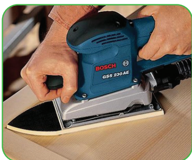
46-rasm. Delta ko'rinishidagi silliqlash mashinasi
